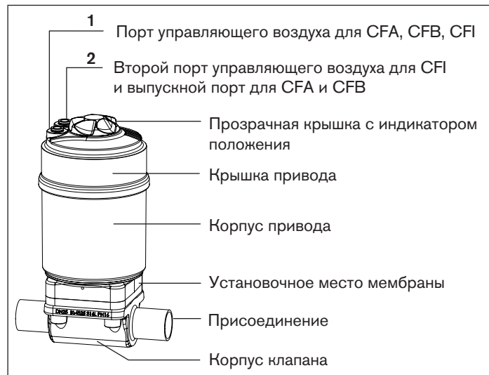
Рис. 1: Мембранный клапан с поршневым приводом, конструкция и описание
