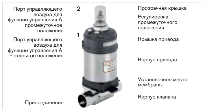
Рис. 2: Конструкция и описание, 2/3 -ходовой клапан тип 2103
